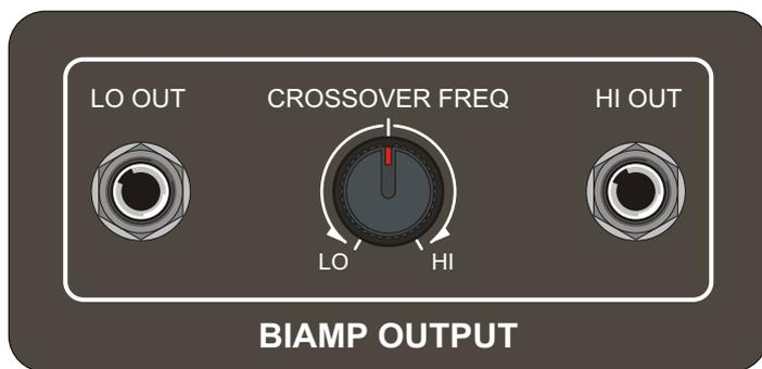
Der SIP-301 konnte Full-Range betrieben werden, er bot aber auch die Möglichkeit, ihn im Bi-Amp-Modus zu fahren. Dann konnte er zwei Endstufen antreiben. Die Crossover Frequenz - also die Frequenz, bei der das Signal aufgeteilt wird - war zwischen 50 Hz und 400 Hz per Regler auf der Rückseite stufenlos einstellbar.
