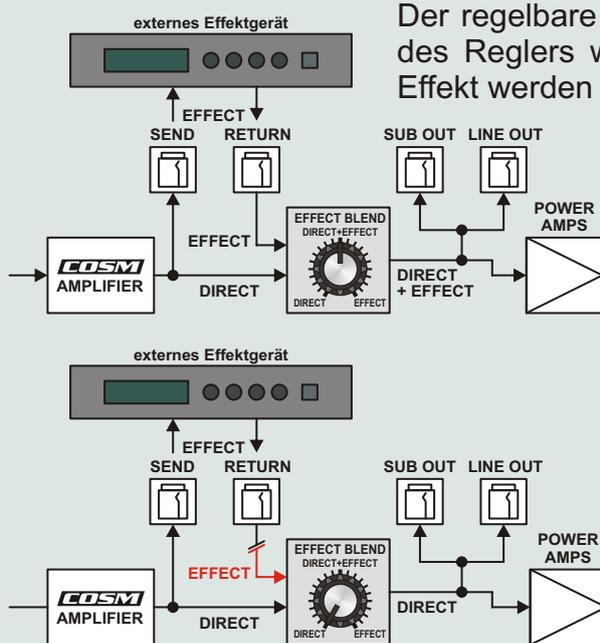
Der regelbare Effektweg des D-BASS wirkt in Mittelstellung des Reglers wie ein paralleler Effektweg. Direktsignal und Effekt werden 50/50 gemischt. Steht der Regler auf DIRECT, kommt kein Effektsignal durch. In EFFECT-Stellung hat man einen seriellen Effektweg. Bietet das Effektgerät die Möglichkeit ein reines Effektsignal zu liefern, kann man mit dem Regler beide Signale stufenlos mischen. Der Regler ist auch bestens dazu
