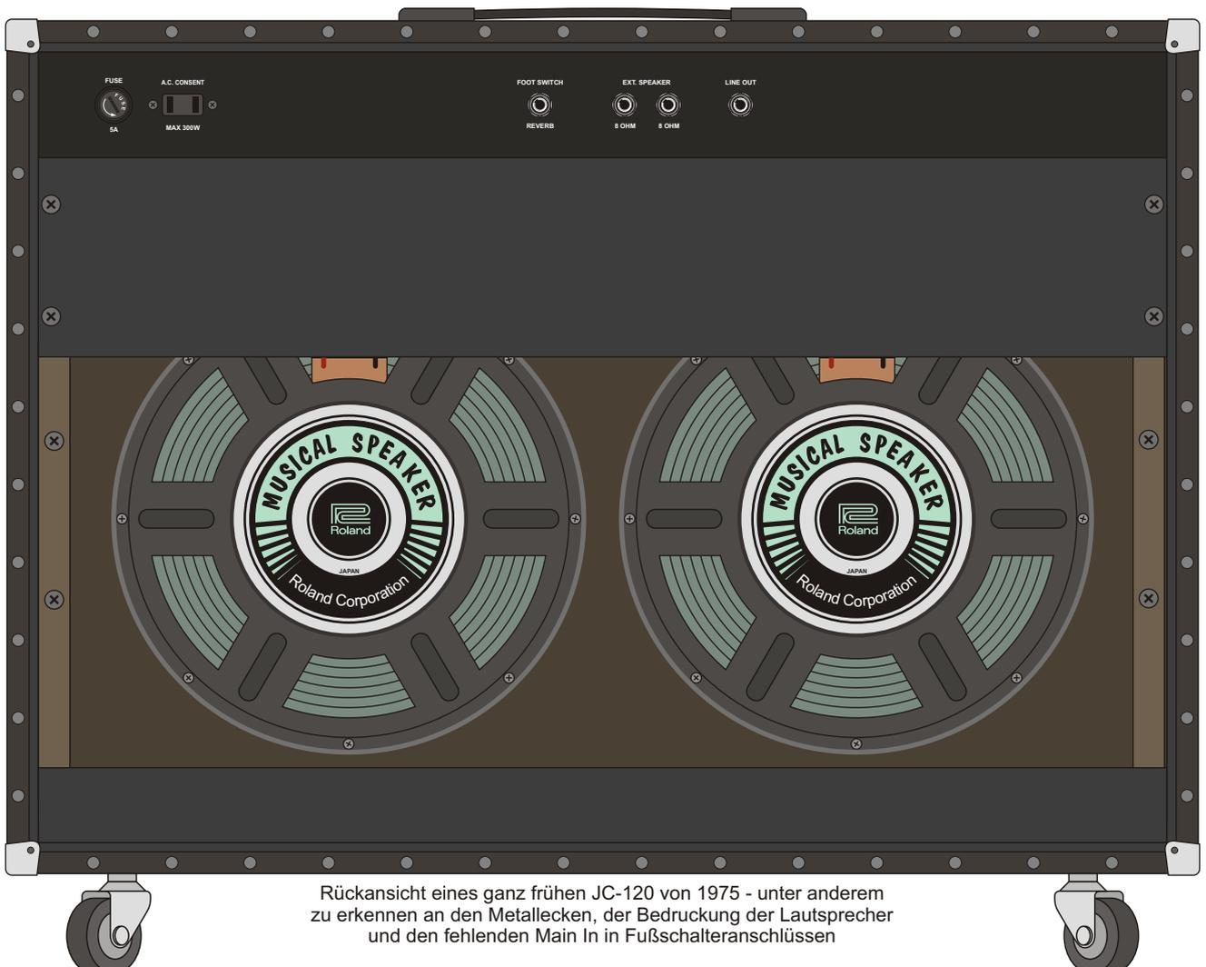
Rückansicht eines ganz frühen JC-120 von 1975 - unter anderem zu erkennen an den Metallecken, der Bedruckung der Lautsprecher und den fehlenden Main In in Fußschalteranschlüssen
