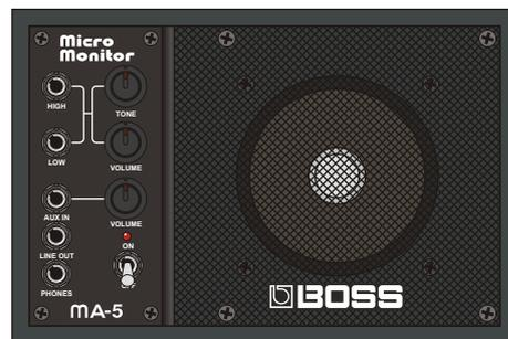
Zumindest theoretisch konnte man das Gehäuse in drei verschiedenen Winkeln (45, 30 und 90 Grad) aufstellen. Ein Gewinde oder eine Aufnahme zur Befestigung an einem Mikrofonständer gab es beim MA-5 Monitor nicht. An Bord war ein 12 cm Lautsprecher. Das Gehäuse war aus dünnen Spanplatten gebaut und mit Vinyl überzogenen, was nicht gerade für optimal Roadtauglichkeit sorgte.
