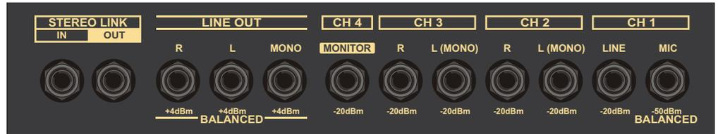
Der KC-300 hatte eine einfachere Klangregelung und war zudem nicht in allen vier Kanälen Stereo ausgelegt. Wie der KC-500 verfügte aber auch er über die so genannte "Stereo Link" Schaltung. Anders als sein großer Bruder hatte der KC-300 keine XLR-Ausgänge zu bieten.
